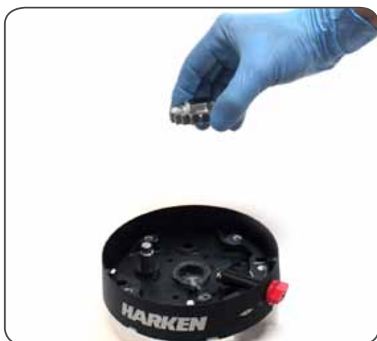
19. Remove the gear n°10
