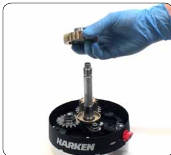
11. Slide out the gear n°32
