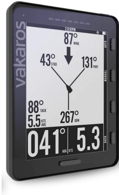
Para configurar el seguimiento de turnos en el Atlas, presione el botón **ÁNGULO** para que aparezca el menú **ÁNGULO**. Hay dos opciones para configurar los ángulos de referencia de babor y estribor, un método automático y un método manual.
