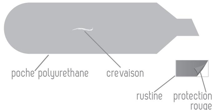
5 Chauffer la rustine, positionnée sur la crevaison, à l'aide d'un sèche-cheveux (environ 1 minute) en gardant une distance de 20 cm (entre la rustine et l'embout chauffant du sèche-cheveux) jusqu'à ce que la rustine adhère en totalité sur toute sa surface, (ne pas maintenir la rustine avec les doigts pendant l'opération).
