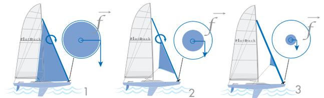
Beginnen sie das Aufrollen mit maximalem Drehmoment, kraftvoller als jede andere Rollanlage! (Bild 1)
