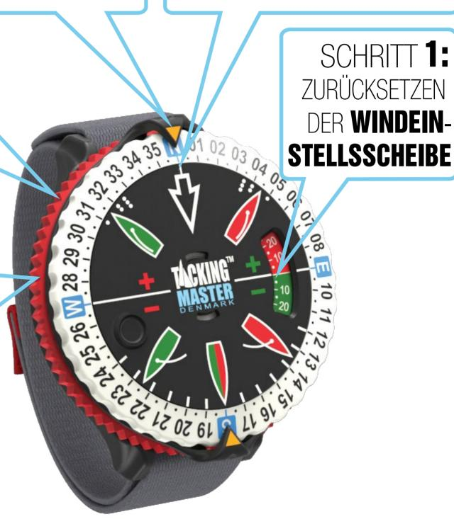
Das "Plus/Minus" auf beiden Seiten der Startlinie ist eine Erinnerung daran, welche Linienseite bevorteilt ist. Die Abbildung zeigt beispielsweise eine auf 300° ausgerichtete Startlinie. Wenn der Wind nun, wie am oberen Pfeil sichtbar. aus 025° kommt, wäre somit die Startlinie am Pin- End (linkes Ende der Startlinie) um 5° bevorteilt.
